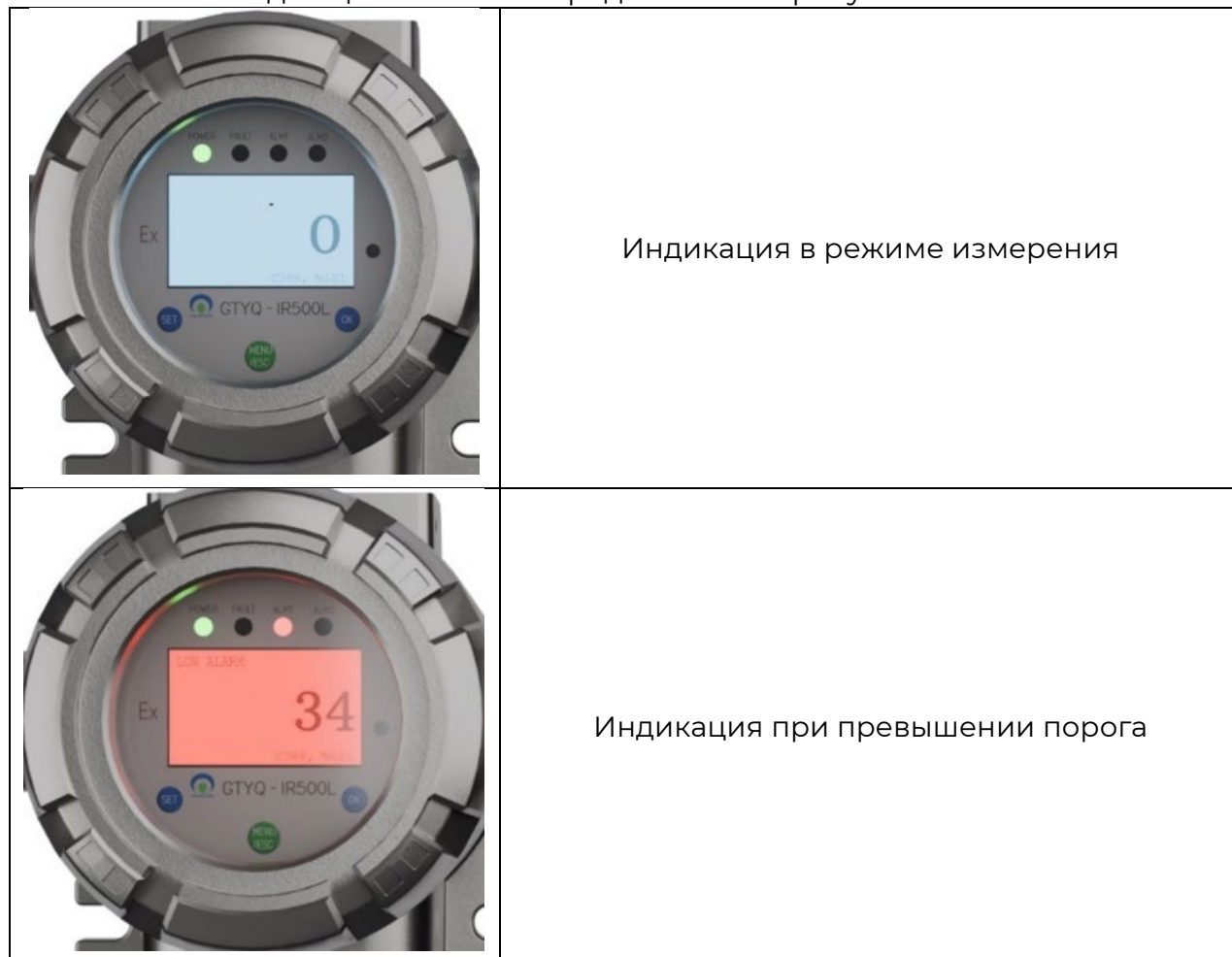
Рисунок 10 - Внешний вид лицевой панели газоанализатора
