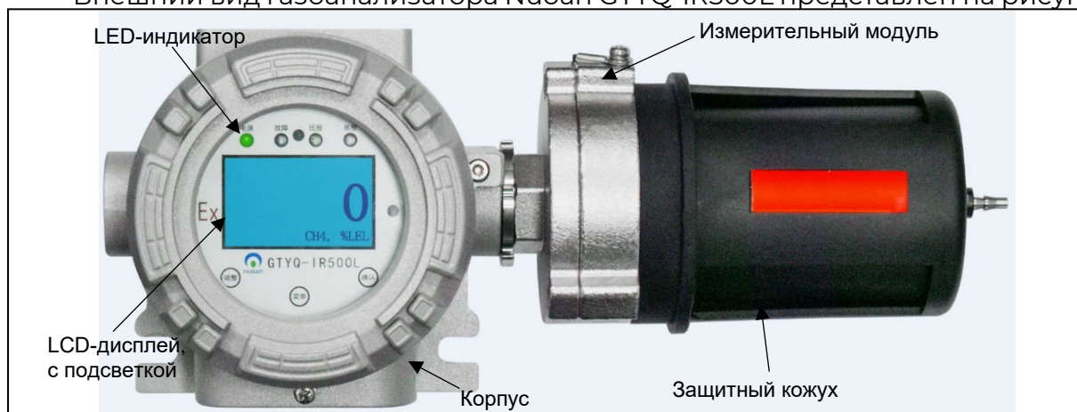
Рисунок 1 - Внешний вид газоанализатора Nuoan GTYQ-IR500L
